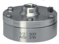
Realizados para aislar el elemento sensible de los manómetros, presostatos y transmisores electrónicos de presión, de fluidos de proceso corrosivos, viscosos, sedimentosos, cristalizables y con altas temperaturas y presión. Una membrana soldada y puesta a prueba antifugas, garantiza la separación del fluido de transmisión del proceso. Las conexiones bridadas según norma ASME-EN1092 nos permite su implantación en instalaciones químicas y petroquímicas, tratamiento de agua y papeleras.
